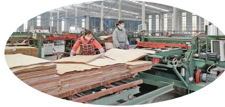
在运输带紧张有序地摆放、粘贴、整理板皮，一块块板皮经过机器生产出木板半成品，车间内一派热火朝天的生产景象。
