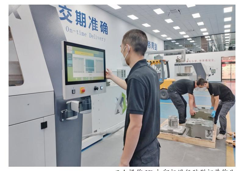
工人操作3D打印机进行砂型订单作业
