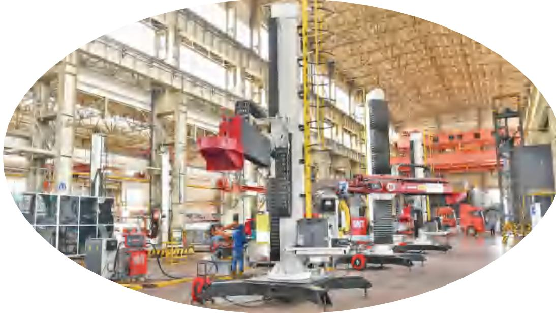
总长400米、跨距36米、高度33米，最大起吊重量550吨，这是东方电机大型清洁能源装备重型制造数字化车间的规模参数。
