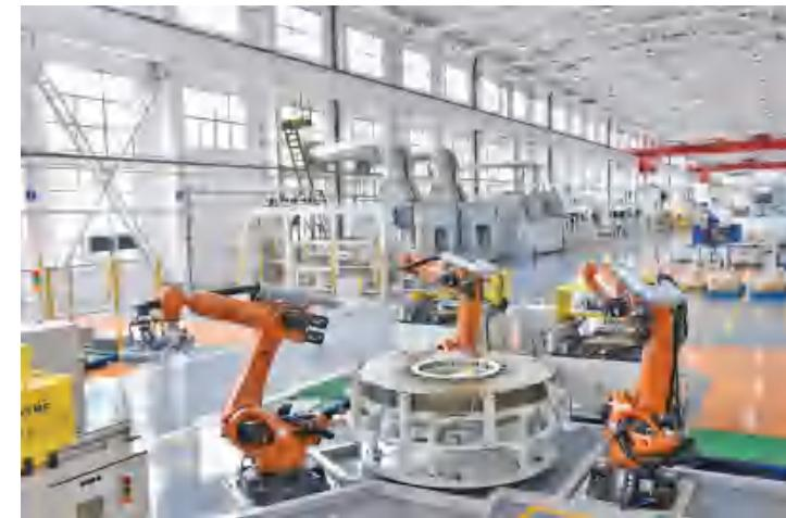
据介绍，以前传统的生产管理完全依赖于人工调度，基本都要手工操作，劳动强度大、粉尘污染重、环保压力大。东方电机建成的数字化车间，设备全部实现自
